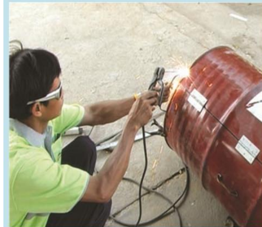
21. และเชื่อมหูจับเหล็กสำหรับยกฝาครอบเปิดปิดด้านบน
