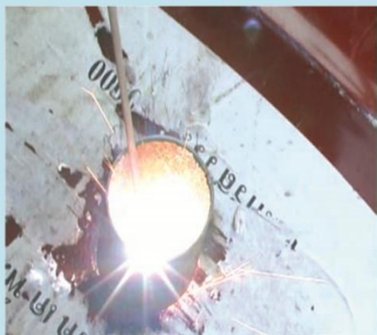
19. ในส่วนของฝาครอบด้านบน เจาะรูขนาดเส้นผ่าศูนย์กลาง 2 นิ้ว
