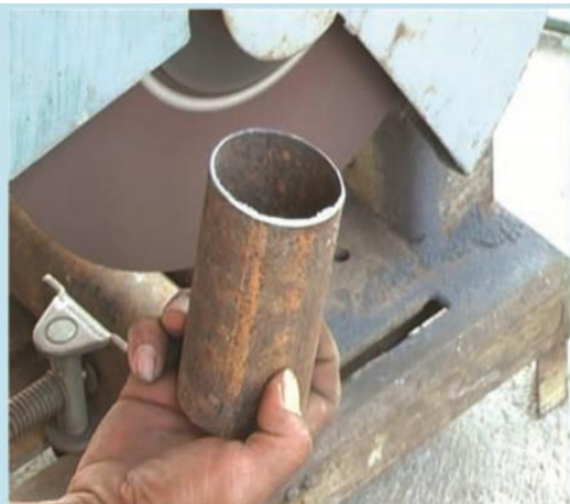
3. ท่อเหล็กขนาดเส้นผ่าศูนย์กลาง 2 นิ้ว สูง 10 เซนติเมตร สำหรับท่อระบายความร้อน
