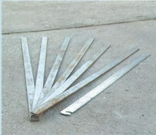
2. เหล็กเส้นแบนขนาดกว้าง 1 นิ้ว สำหรับทำขอบชั้นใน
