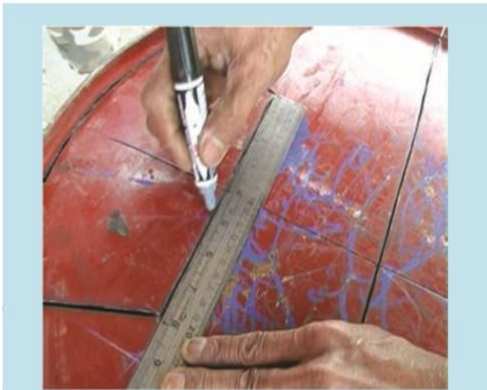
2. ส่วนด้านบนของถังตามแนวตั้ง ให้วัดและตีเส้นขนาด 35 เซนติเมตร คูณ 15 เซนติเมตร เพื่อทำช่องเขี่ยเก้าอี้ ด้านบนของถัง ด้านบนที่เป็นฝาครอบของเตา ให้วัดและตีเส้นขนาด 30 เซนติเมตร คูณ 60 เซนติเมตร เพื่อทำช่องเปิดปิด
