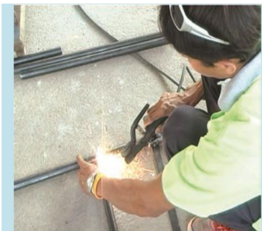
22. นำท่อเหล็กขนาด 1 นิ้ว ยาว 1 เมตร เชื่อมกับเหล็กเส้นแบบ ประกอบเป็นขาตั้งเตา
