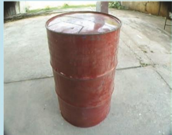
1. ถังน้ำมัน 200 ลิตร รูปทรงกระบอก ขนาดเส้นผ่าศูนย์กลาง ไม่น้อยกว่า 55 เซนติเมตร สูงไม่น้อยกว่า 90 เซนติเมตร
