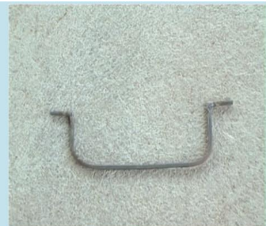
5. हुตะ ทำจากเหล็กเส้นกลมขนาด \text{Ø } \frac{1}{8} "
