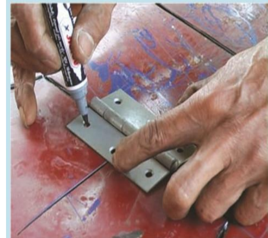
4. ทำเครื่องหมายเพื่อติดตั้งบานพับ
