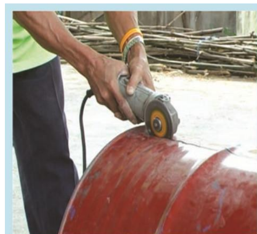
8. ทำการตัดครึ่งถังตามแนวอนด้านหน้าตามเส้นที่กำหนดไว้
