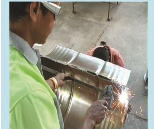
18. ในส่วนของฝาครอบ เชื่อมเหล็กเส้นแบนกับขอบถังด้านใน โดยรอบให้มีระยะห่างจากขอบถัง 1 ถึง 2 เซนติเมตร
