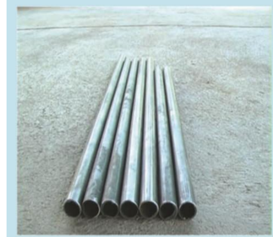
8. ก่อเหล็กขนาดเส้นผ่าศูนย์กลาง 1 นิ้ว ยาว 1 เมตร สำหรับทำขาตั้งเตา
