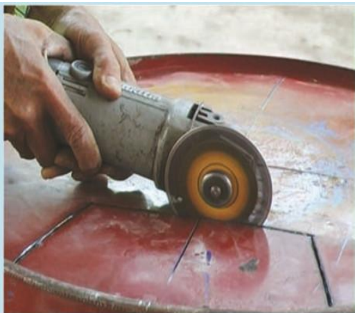
3. ดำเนินการตัดช่องเขี่ยเก้าอี้ก่อนเป็นอันดับแรก โดยตัดตามเส้นที่ได้กำหนดไว้
