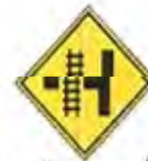
ทางข้ามทางรถไฟ ติดทางแยก
